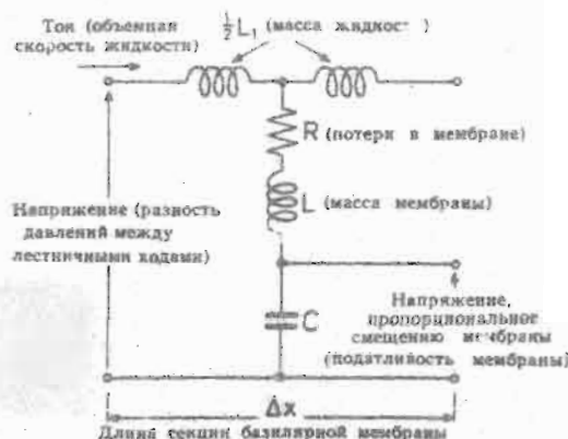
Фиг. 9. Схема небольшой секции базилярной мембраны, составленная на основе электрических аналогий (одно-волновая модель). На низких частотах ( \omega \ll 1/\sqrt{LC} ) данная секция по существу выполняет функции линии задержки. На высоких частотах ( \omega \gg 1/\sqrt{LC} ) она представляет собой (индуктивный) аттенуатор. При \omega = 1/\sqrt{LC} поперечный ток (соответствующий скорости смещения базилярной мембраны) имеет резонансный пик. Различные частоты резонируют на различных участках, расположенных вдоль мембраны.
