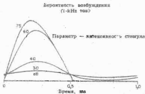
Фиг. 19. Вероятности возбуждения модели [39] для синусоидального акустического сигнала при четырех входных уровнях. Вероятность возбуждения линейно связана с мгновенными значениями сигнала при уровнях не выше 30 dB. При уровнях выше 60 dB вероятность возбуждения соответствует сигналу после однополупериодного выпрямления и при дальнейшем увеличении уровня сигнала изменяется незначительно. Результаты, полученные с помощью этой модели, соответствуют периодическим гистограммам, показанным на фиг. 17.
